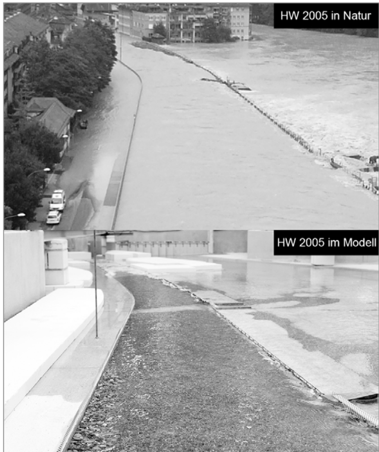
Die Simulation des Hochwassers 2005 im Modell ergab eine sehr genaue Übereinstimmung mit den tatsächlichen Verhältnissen in der Natur.
