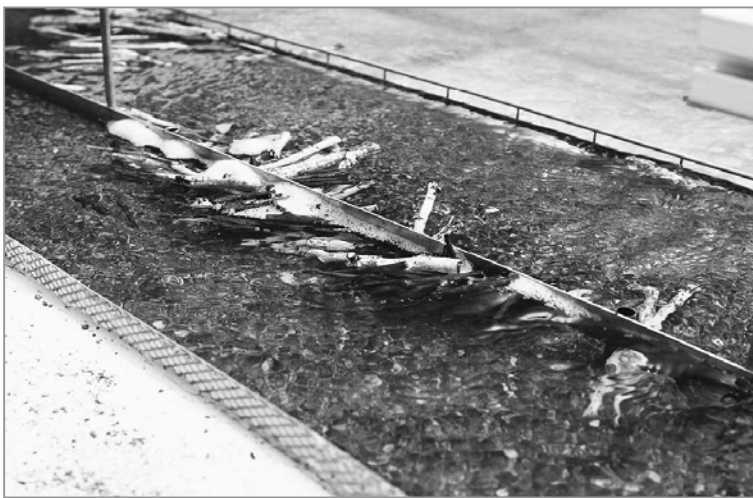
Im Modellversuch sammelt sich im Bereich der Stützen Schwemmholz an. Dies kann zu einer Erosion der Flusssohle führen und die Stabilität des Holzleitsystems gefährden.
